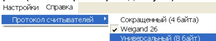
Считыватели IR01 или IR02 могут использовать сокращенный или Weigand 26 протоколы. Режим Weigand 26 - режим, при котором контроллер работает только с нижними 3-мя байтами идентификатора, что позволяет его описать "классическим" способом - разбить его значение на код семейства (число не более 255) и номер (число не более 65535). Подчас именно такие числа можно увидеть на идентификаторах-картах.
