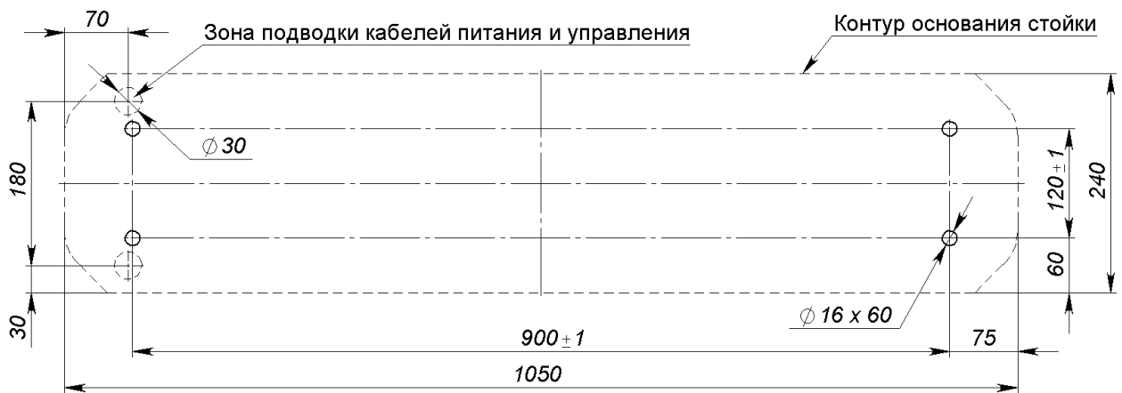
Рисунок 7 — Схема разметки для установки стойки TB01
