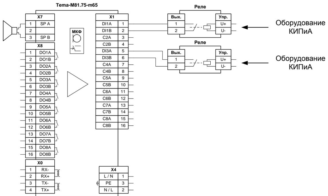
Рисунок 27 – Схема соединений автоинформатора с внешними «сухими» контактами
