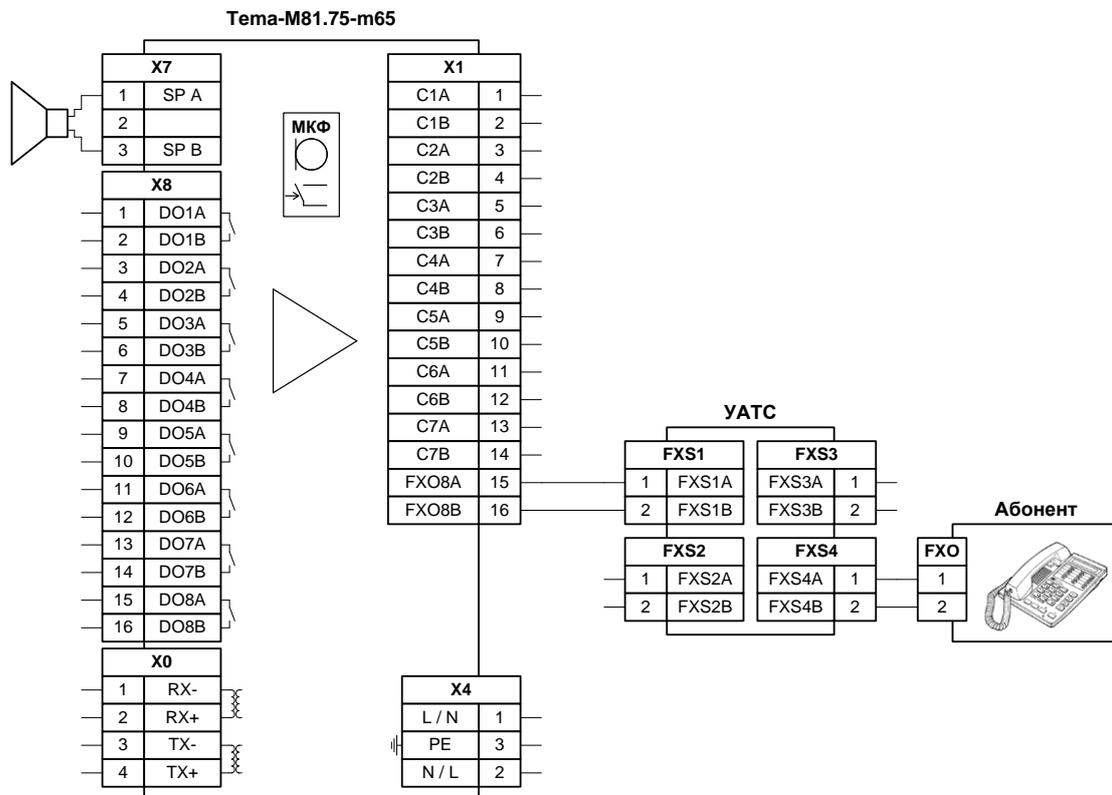
Рисунок 24 – Схема соединений автоинформатора с УАТС
