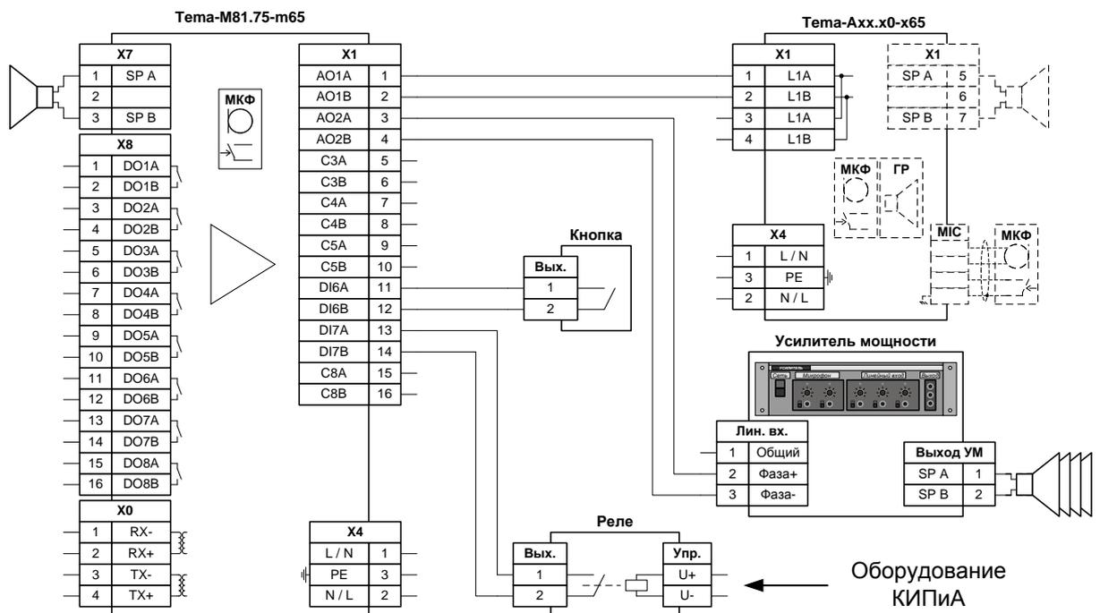
Рисунок 11 – Схема соединений автоинформатора в системе аналоговой ГТС
