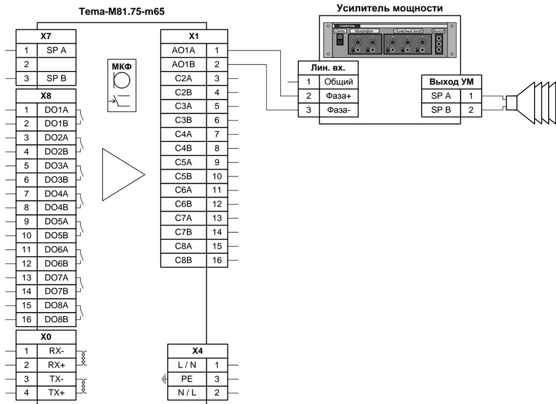
Рисунок 19 – Схема соединений автоинформатора с ручным управлением
