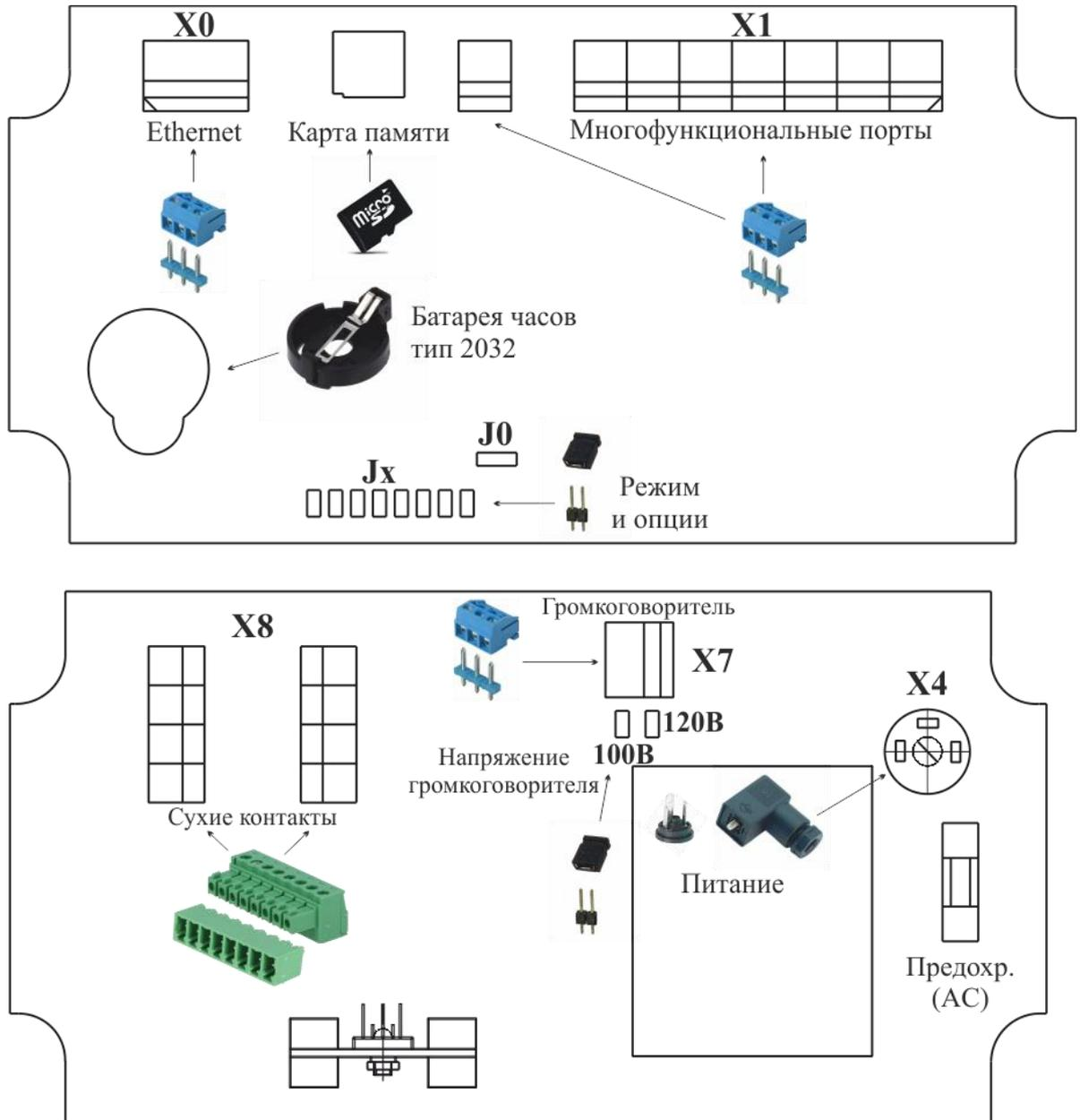
Рисунок 2 – Размещение элементов на платах прибора
