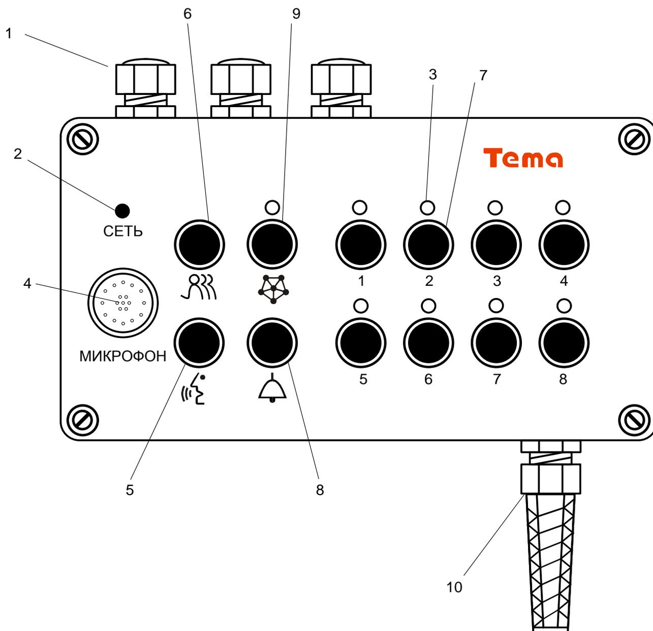
1 – кабельные вводы; 2 – индикатор состояния; 3 – индикаторы номерные; 4 – встроенный микрофон; 5, 6, 7, 8, 9 – кнопки управления; 10 – ввод сетевого провода с амортизатором.
