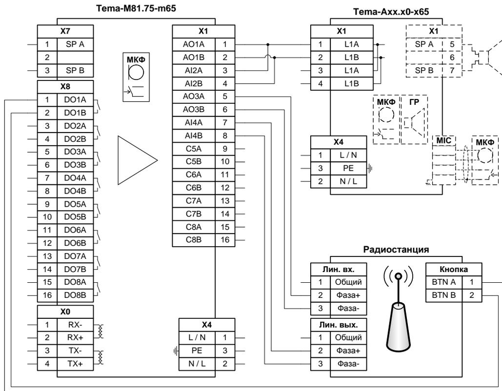
Рисунок 30 – Схема соединений для работы с внешней радиостанцией
