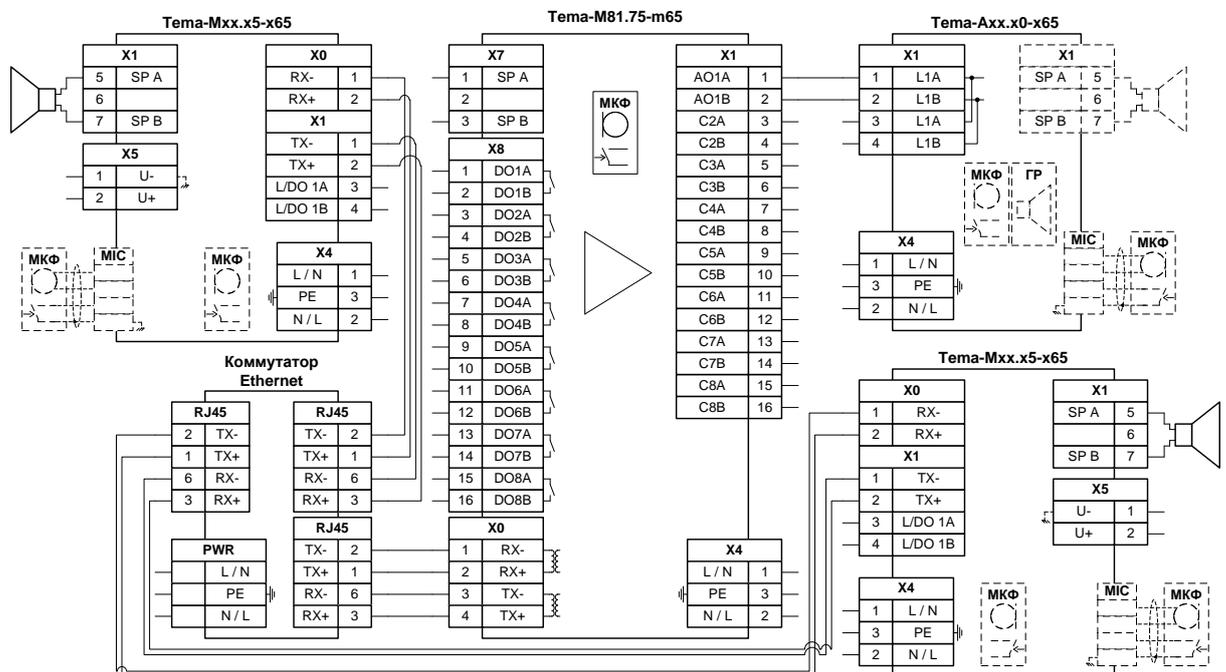
Рисунок 16 – Схема соединений для работы с аналоговой и цифровой системой ГГС
