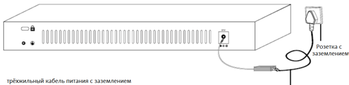
Рисунок 2.7 Заземление с использованием трехжильного кабеля питания
