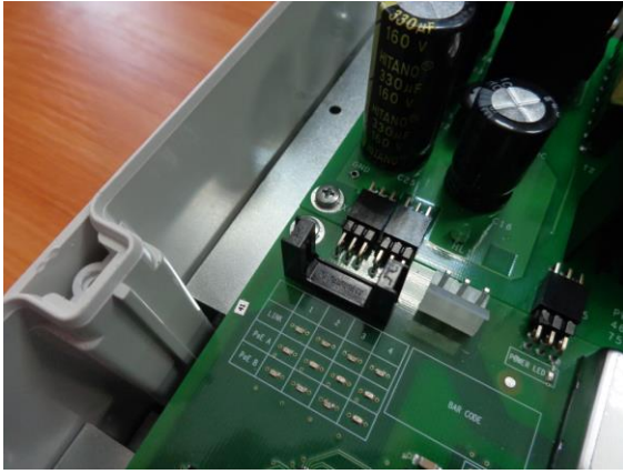
Рис. 2.5-1. Датчика вскрытия на плате
