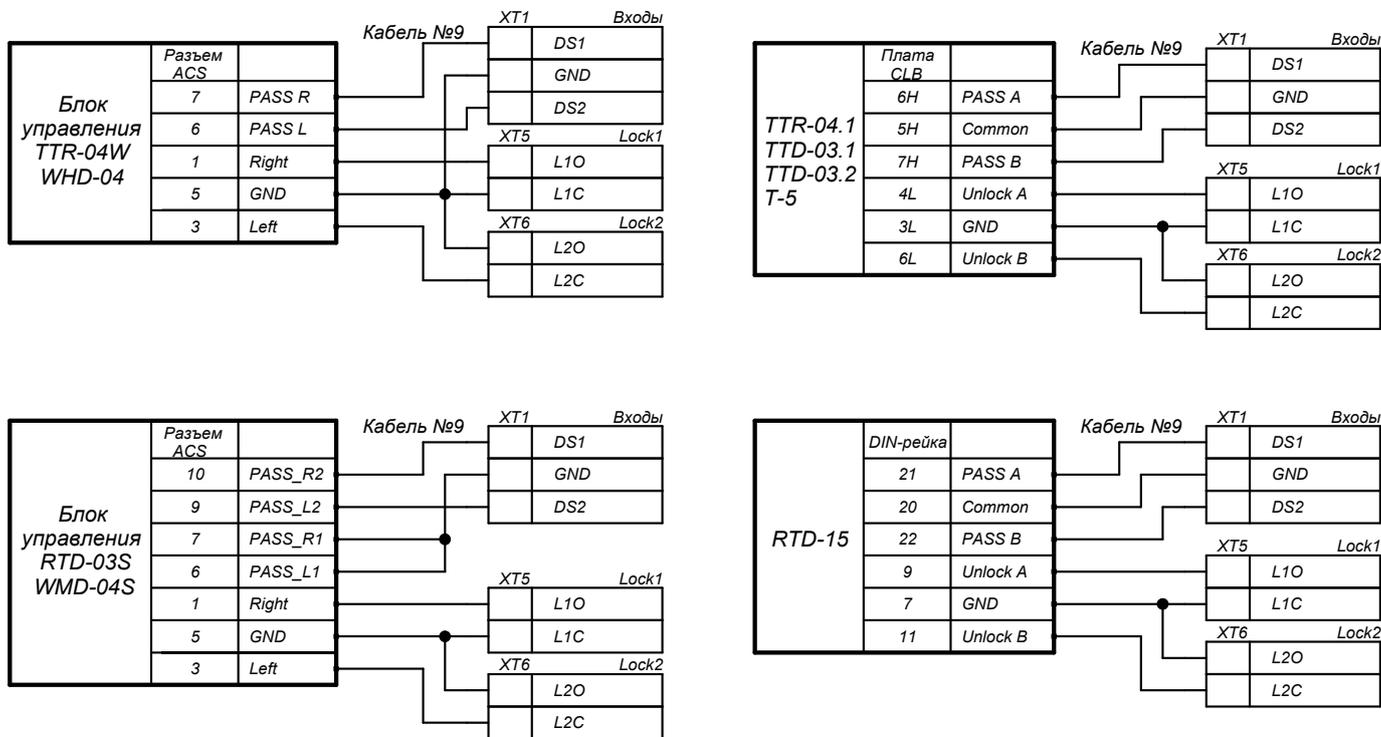
**Рисунок 4 – Схема подключений ИУ в варианте «управление турникетом с УИ»**
