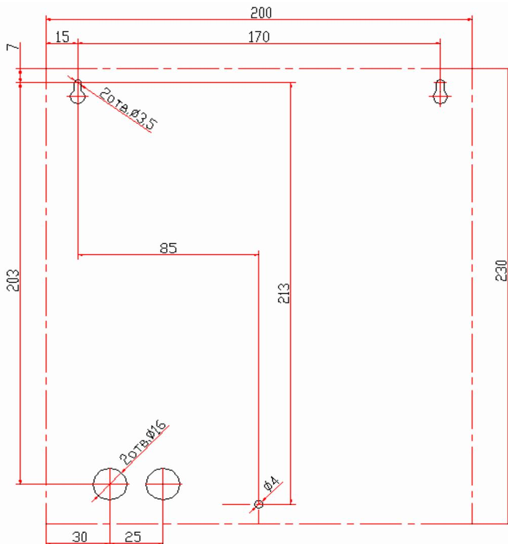
**Рисунок 2 – Разметка отверстий для установки контроллера PERCo-CT/L04 (штрих-пунктиром показаны размеры корпуса контроллера)**
