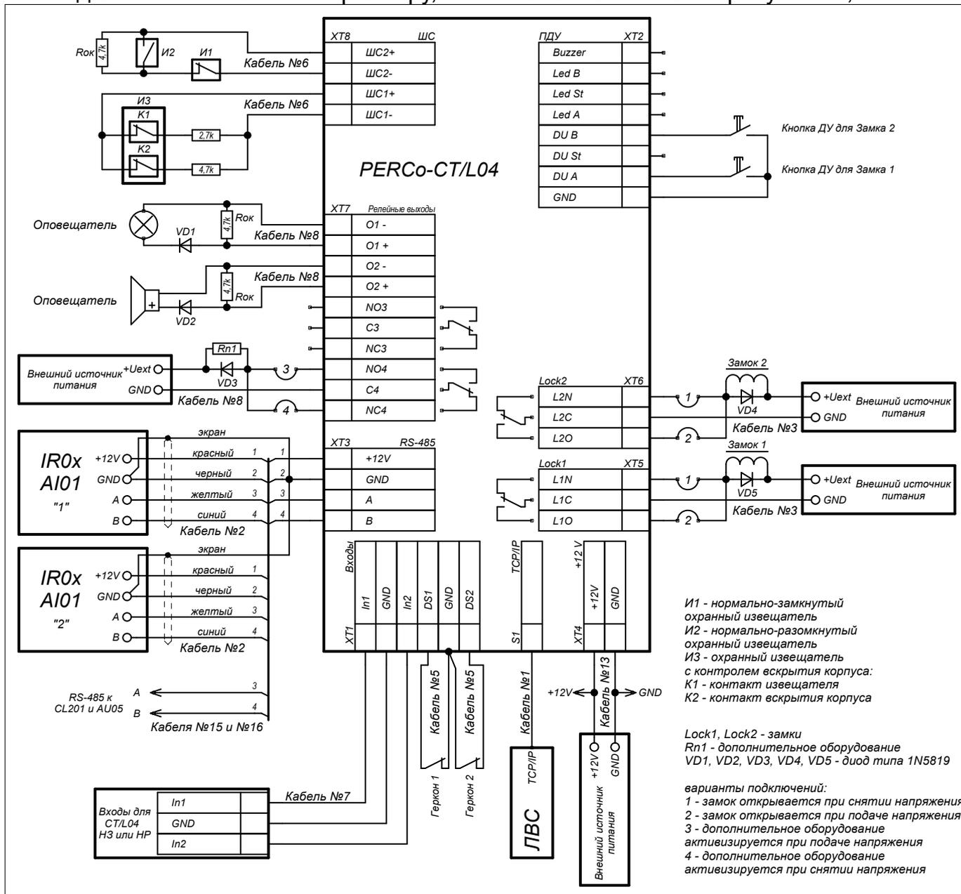
Рисунок 3 – Схема подключений в варианте «управление дверьми»
